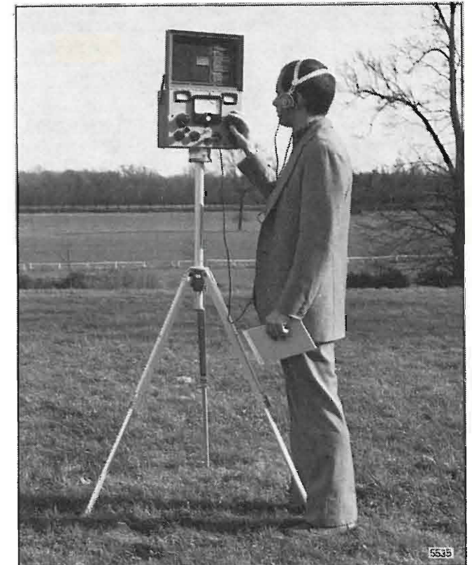
Fig. 3. — Operatore con misuracampo OM in aperta campagna.
